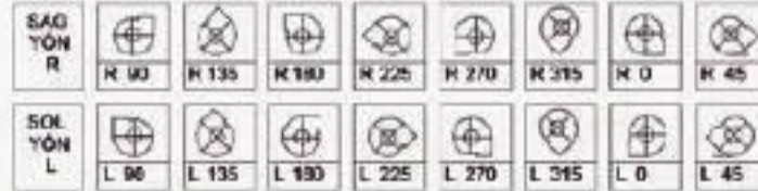
SALYANGOZ TİPİ VANTİLATÖRLERİN POZİSYON ÇİZELİ POSITION DIAGRAM OF CENTRIFUGAL VENTILATORS
